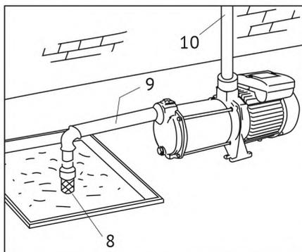
Присоедините напорную трубу (10) к выходному отверстию насоса (7).
