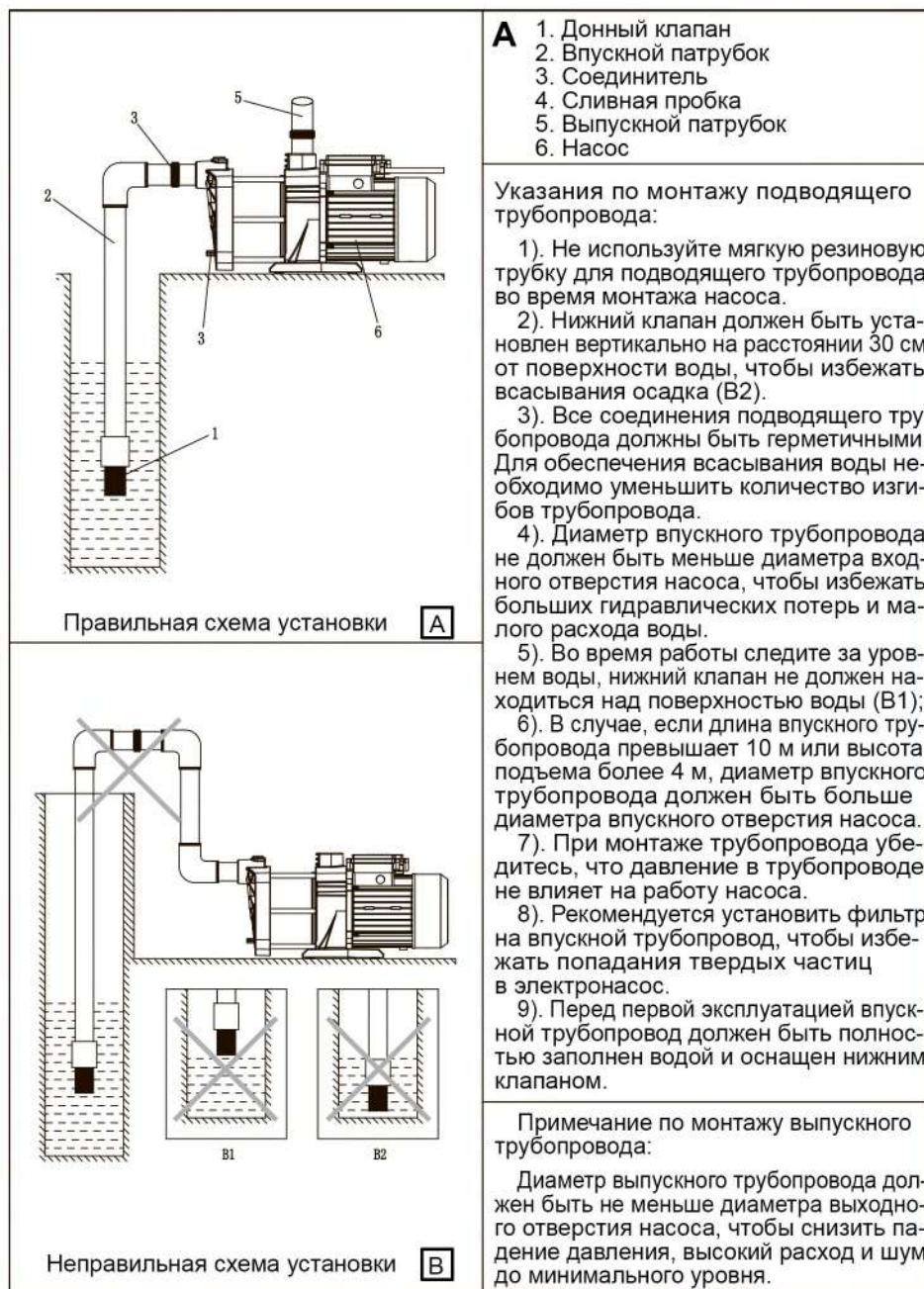
Рисунок 1 Схема установки трубопровода насоса
